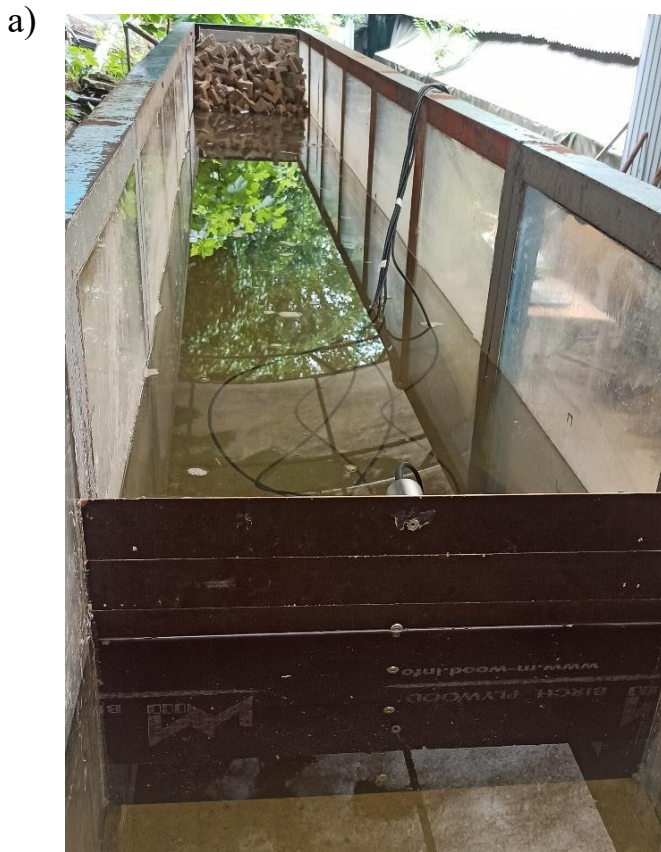
Рисунок 144 - Фотографии моделей сооружения и измерительного оборудования: а) модель без бермы с уровнем +0.0 см; б) модель с бермой и уровнем +0.0 см.
