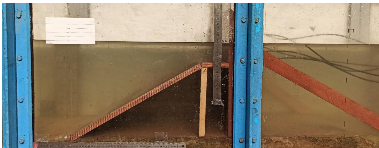
Рисунок 143 - Фотографии моделей сооружения и измерительного оборудования: а) вид поперёк гидроволнового лотка на модель без бермы и уровнем +3.0 см; б) вид поперёк гидроволнового лотка на модель с бермой и уровнем +0.0 см.
