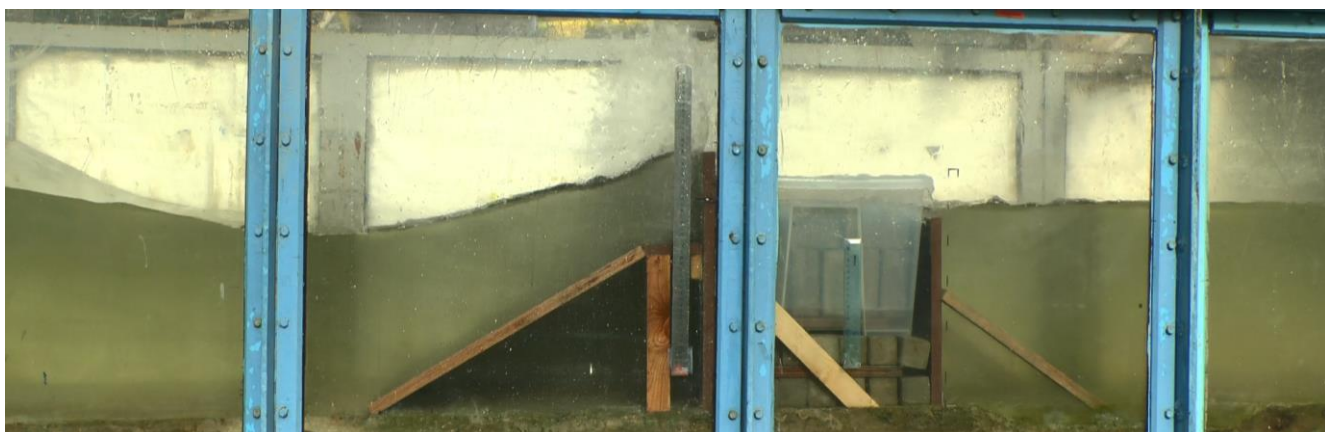
Рисунок 156 - Реализованная модель с ёмкостью из пластика с герметичной крышкой.
