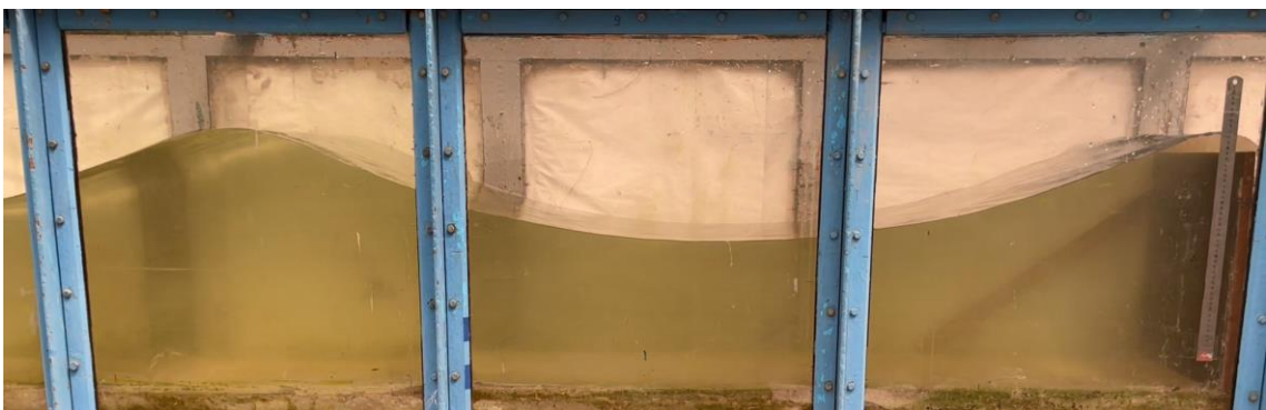
Рисунок 148 - Фотография замоделированной стоячей волны в момент перелива через модель вертикального ПГТС ( R_c = 2.7 м, уровень +0.0 см) при \frac{R_c}{h_i} \cong 0.426 .
