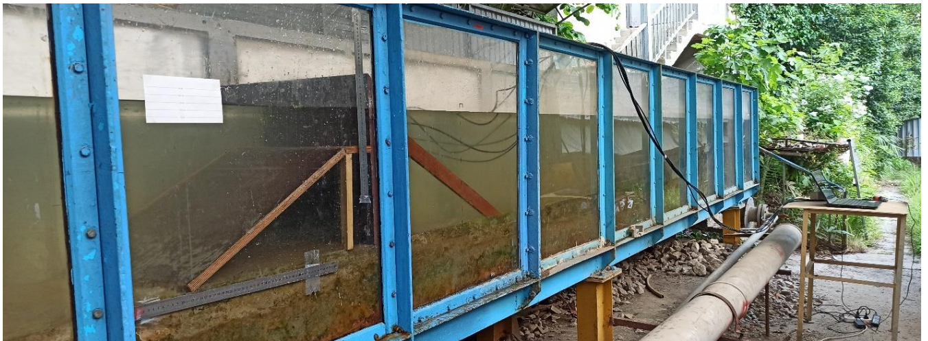
Рисунок 145 - Фотографии модели сооружения с бермой (вид сбоку по направлению от волнопродуктора), измерительное оборудование и компьютер с установленным ПО для сбора и визуализации данных, получаемых с датчиков давления Keller PR-41X.
