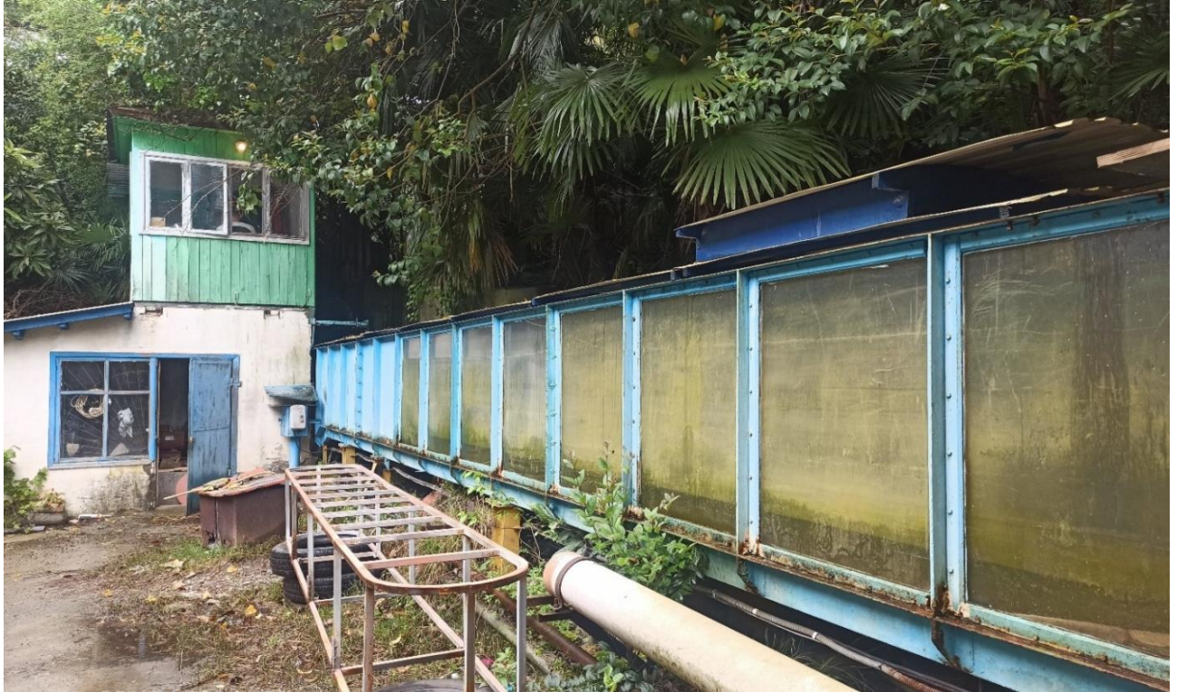
Рисунок 133 - Гидроволновой лоток для гидравлического моделирования.
