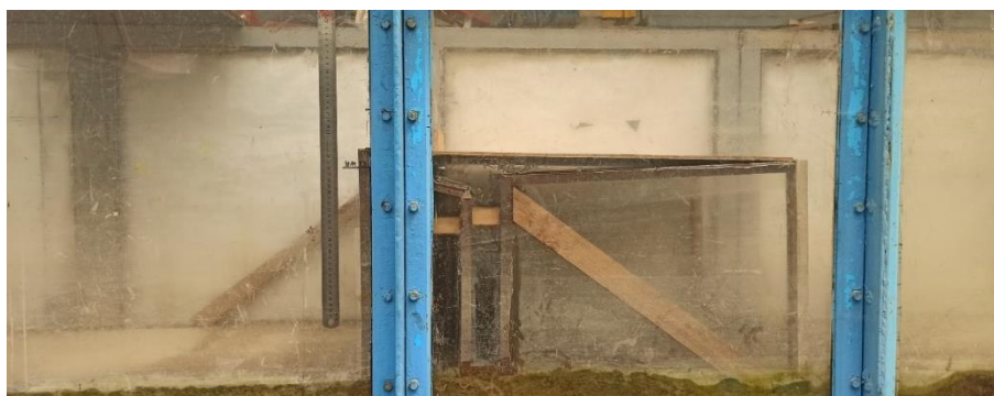
Рисунок 155 - Реализованная модель с ёмкостью в виде сосуда с «воронкой» и деревянным щитом.
