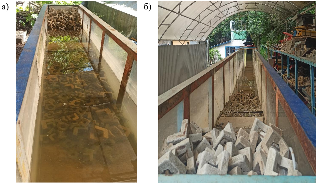
Рисунок 136 - Волногасящее покрытие из фасонных массивов в гидроволновом лотке для гидравлического моделирования. а) Вид по направлению от волнопродуктора; б) Вид по направлению к волнопродуктору.
