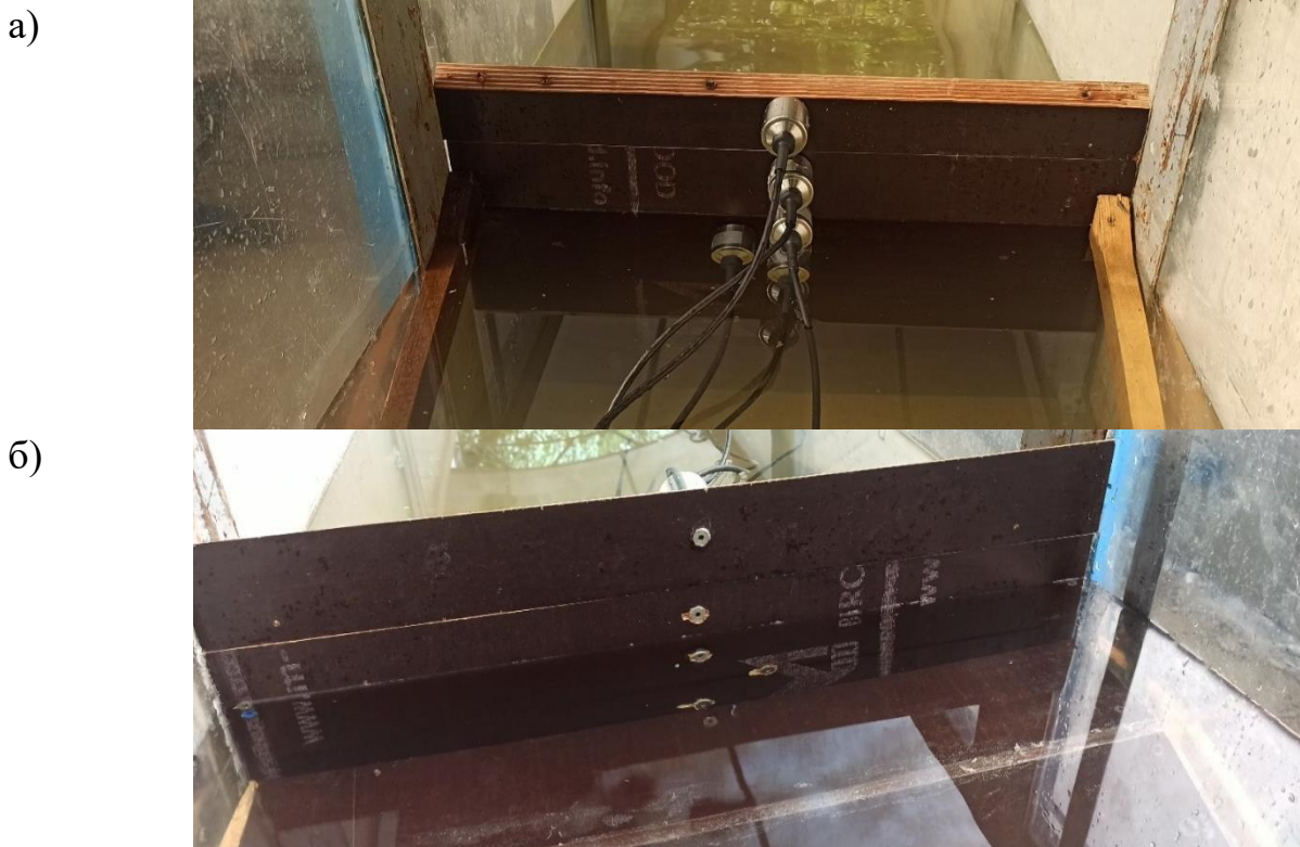
Рисунок 142 - Фотографии расположения датчиков волнового давления на модели сооружения с бермой: а) вид по направлению к волнопродуктору; б) вид по направлению от волнопродуктора.
