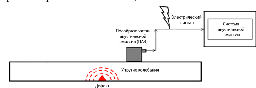
Рис. 1. Метод акустической эмиссии
