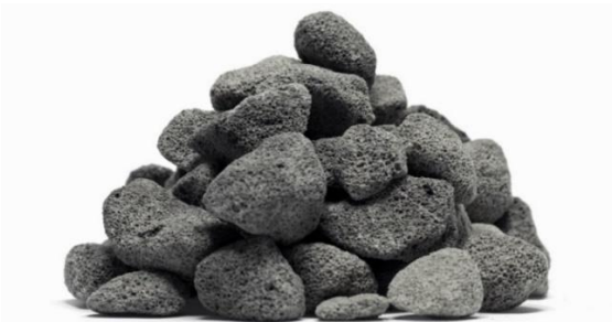
Рис.2. Пеностекольный щебень на основе бутылочного стеклобоя
