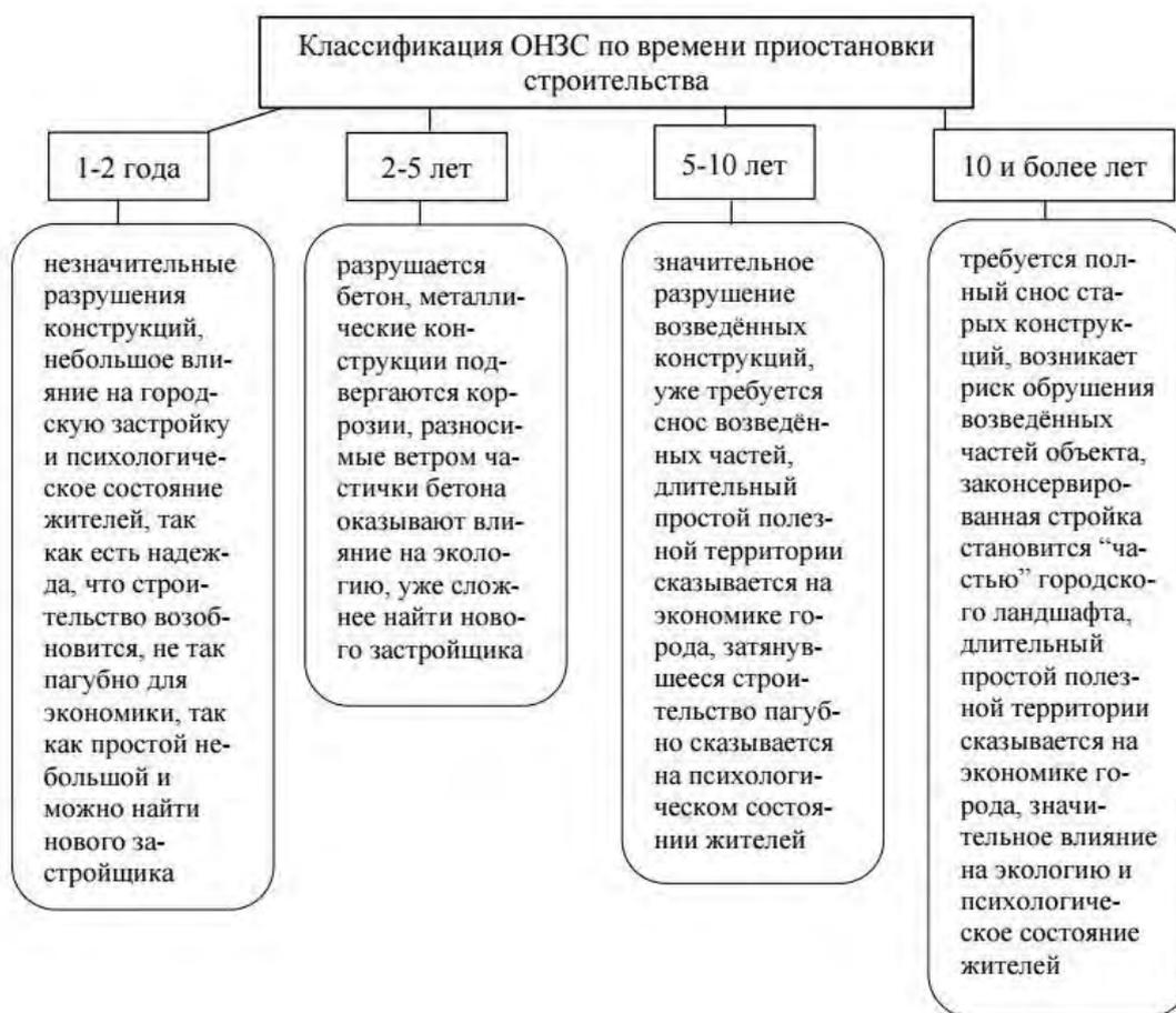
**Рис. 5.** Классификация ОНЗС по времени приостановки строительства
