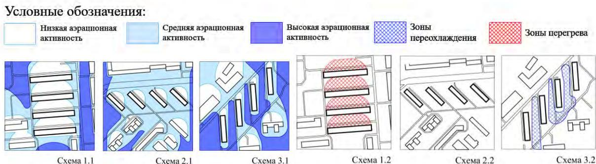
**Рис. 2.** Схемы анализа ветрового воздействия на застройку строчного типа относительно господствующего ветра г. Новосибирска.
