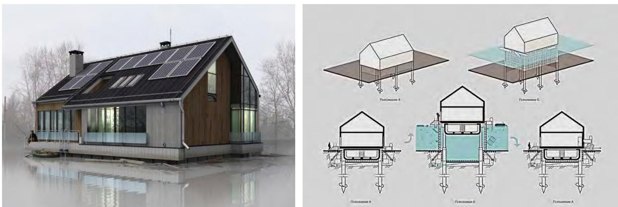
**Рис. 3.** Принцип работы независимого подъёмно-спускового механизма понтонового дома в проектом предложении инженера-архитектора А. Кузьминых.
